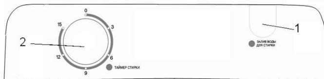
1 - отверстие для залива воды; 2 - таймер стирки.
